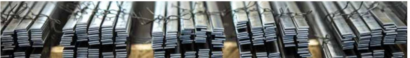
Ce sont des fers en acier soudable, laminés à chaud ou à froid. Ils servent à la construction métallique. Les dimensions sont : 16 / 20 / 25 / 30 / 40 mm.
